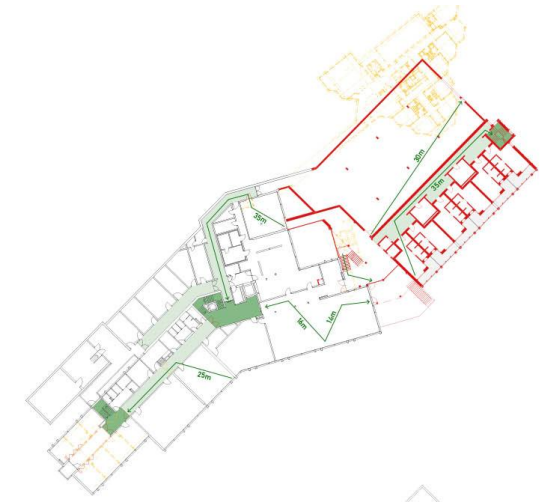
Abbruch/NEU Vertikale & Horizontale Fluchtwege
